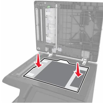
**5** Schließen Sie die Scannerabdeckung, um das ADZ-Scanpad an die Abdeckung zu kleben und öffnen Sie die Abdeckung.
