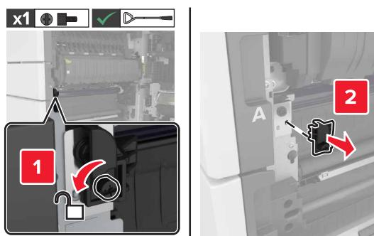
4 Lösen Sie die Schrauben der Transfermodulsperre.
