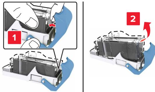
**4** Setzen Sie die neue Kassette in den Heftklammerhalter ein.
