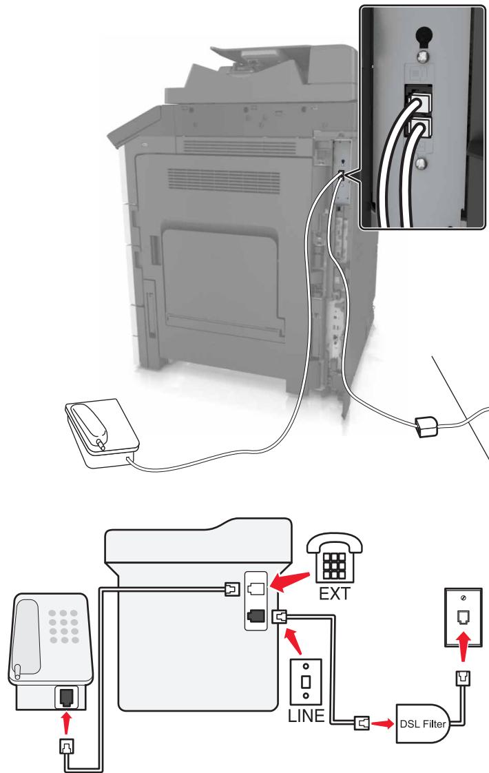
Durch DSL wird Ihre normale Telefonleitung in zwei Kanäle unterteilt: Sprache und Internet. Telefon- und Faxsignale nutzen den Sprachkanal, während Internet-Signale den anderen Kanal verwenden. Auf diese Weise können Sie dieselbe Leitung für analoge Sprachanrufe (einschließlich Faxnachrichten) und digitalen Internet-Zugriff verwenden.
