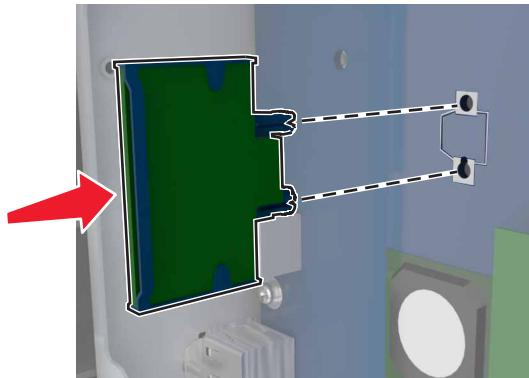
**Warnung - Mögliche Schäden:** Wird die Karte nicht ordnungsgemäß installiert, kann dies u. U. zu Beschädigungen der Karte und der Controller-Platine führen.
