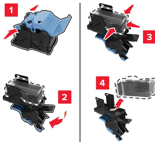
**4** Setzen Sie die neue Kassette in den Heftklammerhalter ein.
