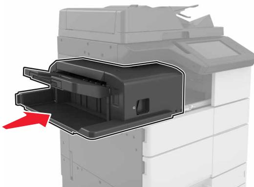
**4** Öffnen Sie Klappe C, und entfernen Sie dann u. U. gestautes Papier.
