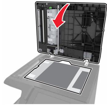
**6** Drücken Sie auf die Ecken des ADZ-Scanpads, um sicherzustellen, dass es hält.
