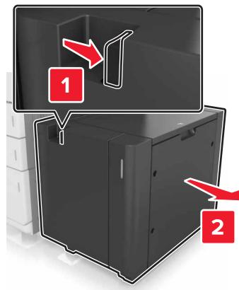
2 Öffnen Sie Klappe D, und entfernen Sie dann gestautes Papier.
