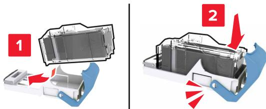
**5** Drücken Sie den Heftklammerhalter fest in den Finisher, bis der Halter mit einem *Klick* einrastet.
