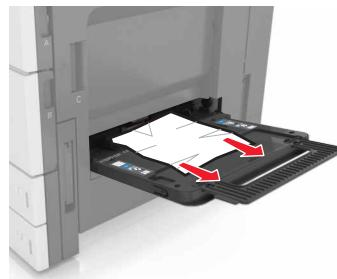
3 Öffnen Sie Klappe C und entfernen Sie sämtliche Papierteile.
