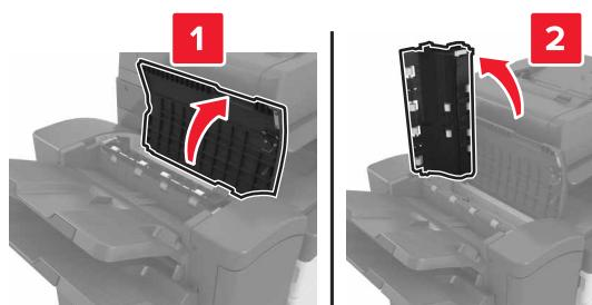
**3 Öffnen Sie Klappe H.**
