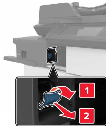
**3** Entfernen Sie die leere Heftklammerkassette aus dem Heftklammerhalter.
