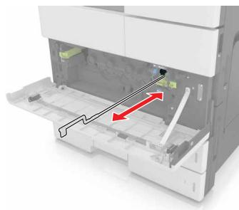
5 Entfernen Sie das Druckkopfwischblatt.
