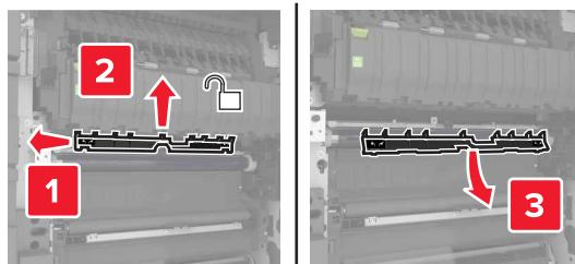
6 Heben Sie das Transfermodul mithilfe der Griffe an und ziehen Sie es komplett heraus.
