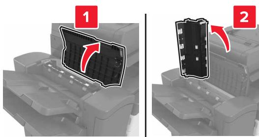
**2 Öffnen Sie Klappe H.**
