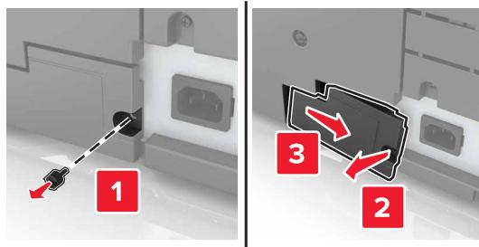
**2** Entfernen Sie die Schrauben aus der Controller-Platinenabdeckung.
