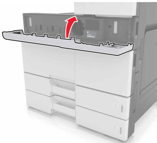
**7** Reinigen Sie den Lader und die Druckkopflinse. Weitere Informationen finden Sie unter "[Reinigung des Laders und der Druckkopflinse](#)" auf Seite 210.
