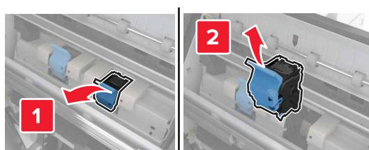
**3** Entfernen Sie die leere Heftklammerkassette aus dem Heftklammerhalter.
