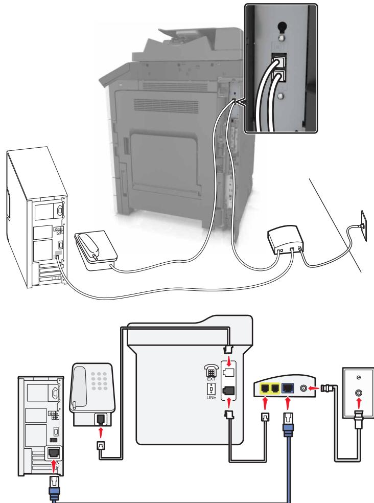
**1** Schließen Sie ein Ende des Telefonkabels, das im Lieferumfang des Druckers enthalten ist, an den Anschluss
