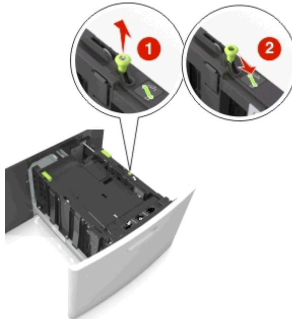
b Drücken Sie die Längenführung zusammen, und schieben Sie sie in die Position für A5-Format, bis sie *hörbar* einrastet.
