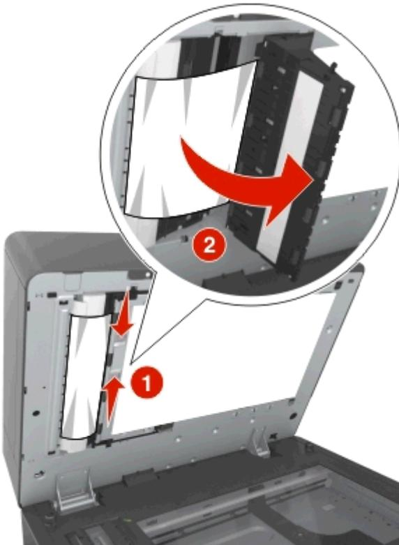
7 Schließen Sie die Klappe an der Unterseite der ADZ.
