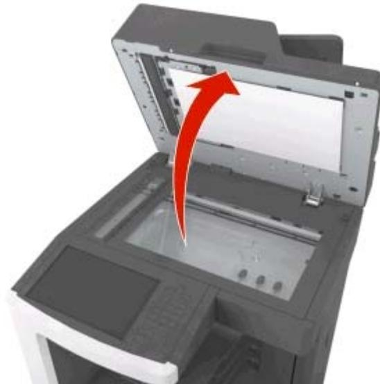
**3** Entfernen Sie die weiße Unterseite der Scannerabdeckung.
