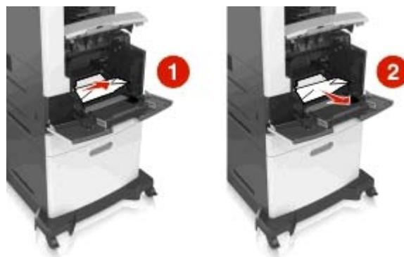
**Warnung - Mögliche Schäden:** Auf dem gestauten Papier befindet sich unter Umständen Toner, der auf Kleidung und Haut Flecken hinterlassen kann.
