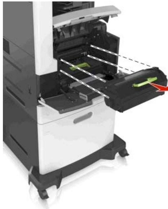
**3** Heben Sie den grünen Hebel an und ziehen Sie dann die Belichtungseinheit aus dem Drucker heraus.
