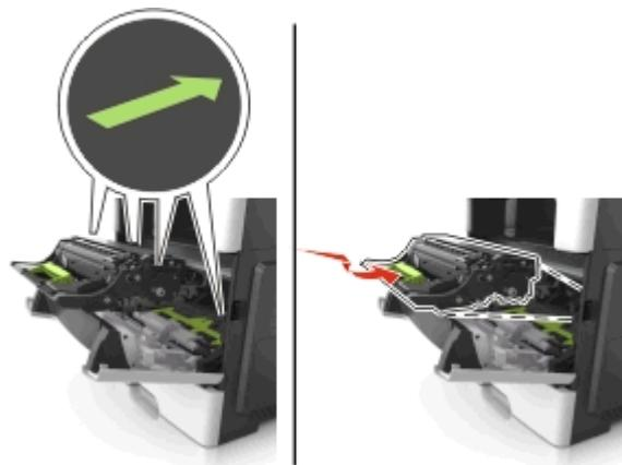
8 Führen Sie die Tonerkassette ein, indem Sie die seitlichen Führungen der Kassette auf die Pfeile an den seitlichen Führungen im Drucker ausrichten, und setzen Sie die Kassette dann in den Drucker ein.
