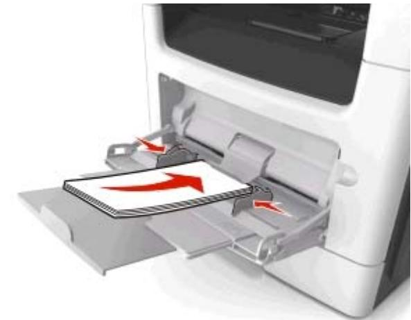
**Warnung - Mögliche Schäden:** Es dürfen keine Briefumschläge mit Briefmarken, Metallklammern, Haken, Fenstern, Füller oder selbstklebenden Aufklebern verwendet werden. Durch solche Briefumschläge kann der Drucker schwer beschädigt werden.
