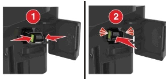
**7** Tauschen Sie den Ersatzheftklammerbehälter aus, damit in Zukunft ein Behälter zur Verfügung steht.
