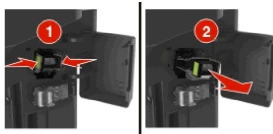
**3** Fassen Sie den leeren Heftklammerbehälter an beiden Seiten mit den Fingern und ziehen und heben Sie dann den leeren Heftklammerbehälter aus der Kassette.
