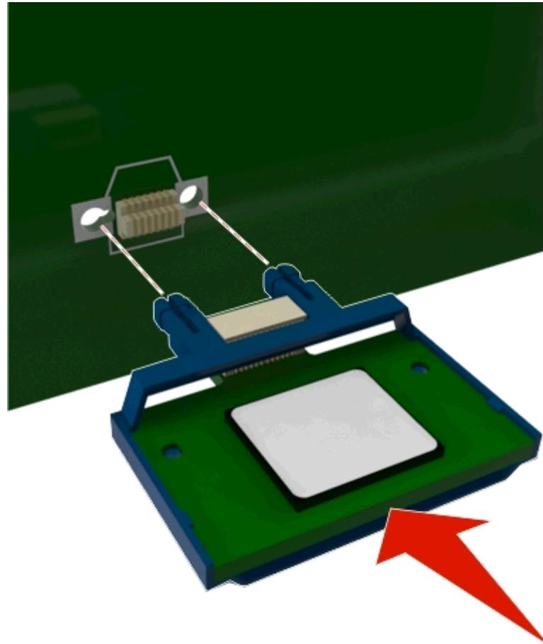
**Warnung - Mögliche Schäden:** Ein unsachgemäßer Einbau der Karte kann Schäden an der Karte und an der Steuerungsplatine zur Folge haben.
