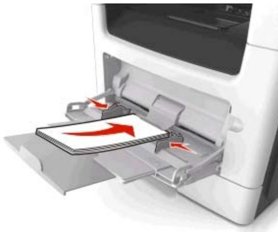
**Warnung - Mögliche Schäden:** Es dürfen keine Briefumschläge mit Briefmarken, Metallklammern, Haken, Fenstern, Fütterung oder selbstklebenden Aufklebern verwendet werden. Durch solche Briefumschläge kann der Drucker schwer beschädigt werden.
