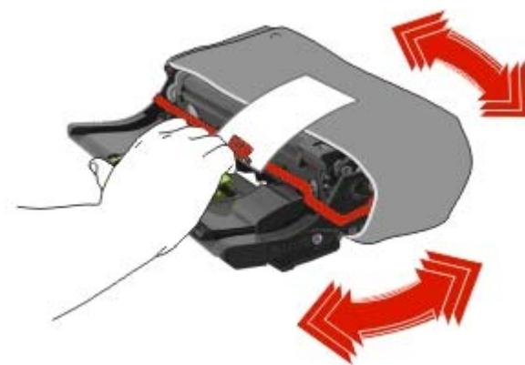
**5** Entfernen Sie das gesamte Verpackungsmaterial von der Belichtungseinheit.
