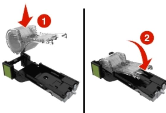
**6** Schieben Sie die Heftklammerkassette so in den Finisher, dass sie *hörbar* einrastet.
