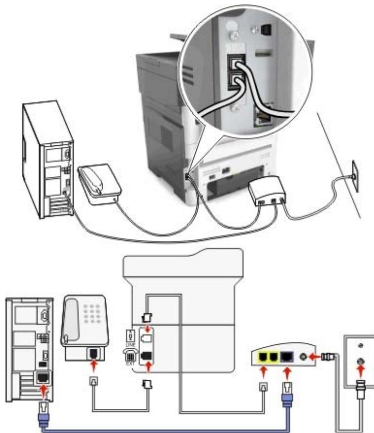
**1** Schließen Sie ein Ende des Telefonkabels, das im Lieferumfang des Druckers enthalten ist, an den Anschluss
