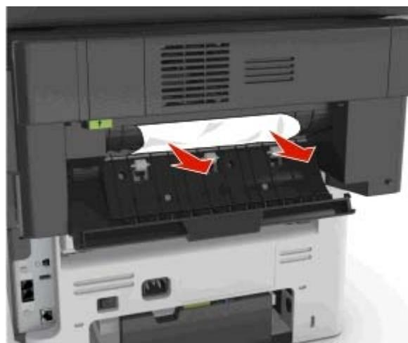
**3** Öffnen Sie die Finisher-Zugriffsklappe und entfernen Sie dann sämtliche Papierteile innerhalb der Zugriffsklappe.
