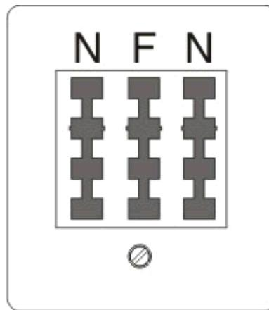
Schließen Sie den Drucker an einen beliebigen N-Anschluss an.
