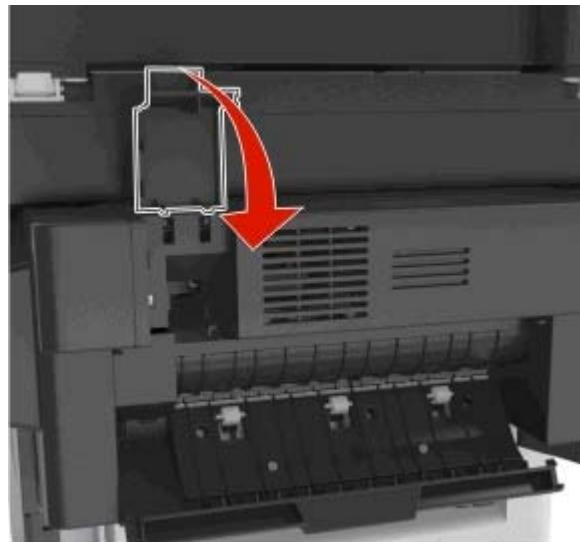
**5** Schließen Sie die hintere Finisher-Klappe.
