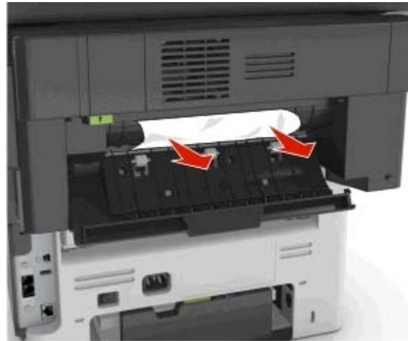
**3** Öffnen Sie die Finisher-Zugriffsklappe und entfernen Sie sämtliche Papierteile innerhalb der Zugriffsklappe.
