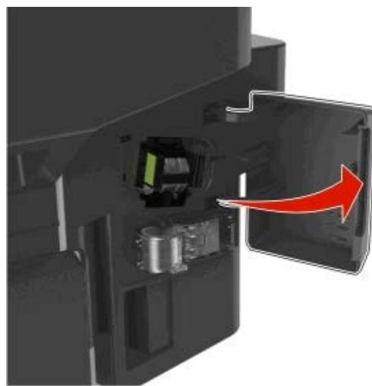
**2** Ziehen Sie die Heftklammerkassette aus dem Finisher heraus.
