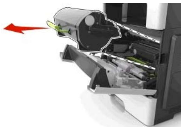
**3** Heben Sie den grünen Hebel an und ziehen Sie dann die Belichtungseinheit vollständig aus dem Drucker heraus.
