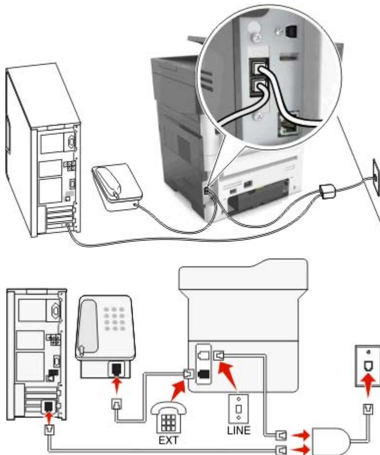
Durch DSL wird Ihre normale Telefonleitung in zwei Kanäle unterteilt: Sprache und Internet. Telefon- und Faxsignale nutzen den Sprachkanal, während Internet-Signale den anderen Kanal verwenden. Auf diese Weise können Sie dieselbe Leitung für analoge Sprachanrufe (einschließlich Faxnachrichten) und digitalen Internet-Zugriff verwenden.
