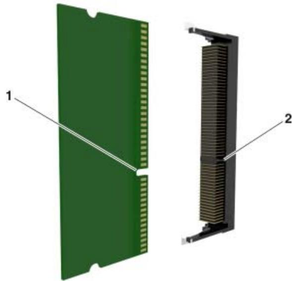
**4** Drücken Sie die Speicherplatine gerade in den Steckplatz und schieben Sie die Karte dann in Richtung der Steuerungsplatinenwand, bis sie *hörbar* einrastet.
