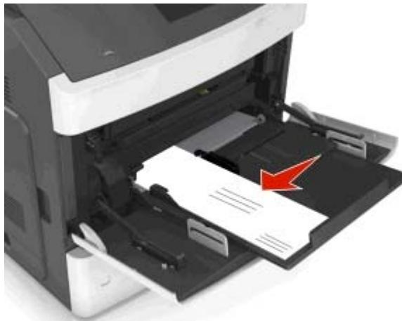
**Warnung - Mögliche Schäden:** Es dürfen keine Umschläge mit Briefmarken, Metallklammern, Haken, Fenstern, Fütterung oder selbstklebenden Aufklebern verwendet werden. Durch solche Umschläge kann der Drucker schwer beschädigt werden.
