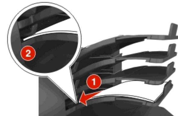
**Hinweis:** Wenn sich das Papier nicht unter dem Ablagearm befindet, tritt ein Papierstau aufgrund einer überfüllten Ablage auf.
