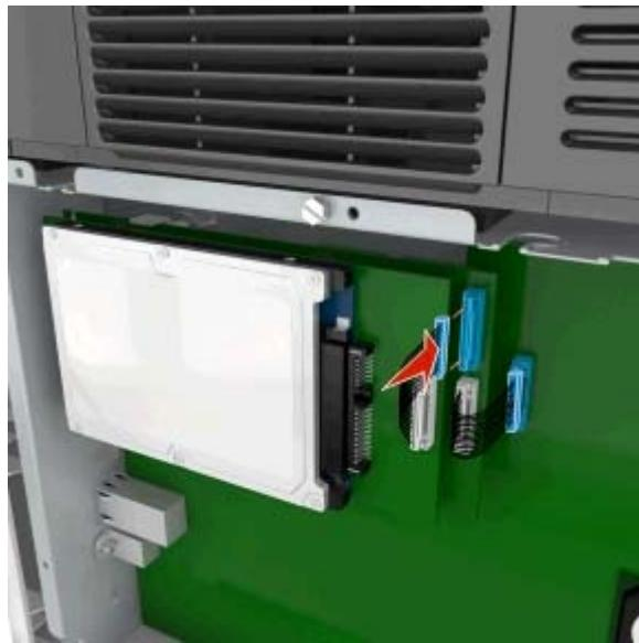
So installieren Sie die Druckerfestplatte direkt auf der Controller-Platine:
