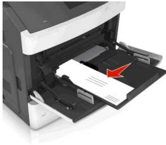
**Warnung - Mögliche Schäden:** Es dürfen keine Umschläge mit Briefmarken, Metallklammern, Haken, Fenstern, Fütterung oder selbstklebenden Aufklebern verwendet werden. Durch solche Umschläge kann der Drucker schwer beschädigt werden.
