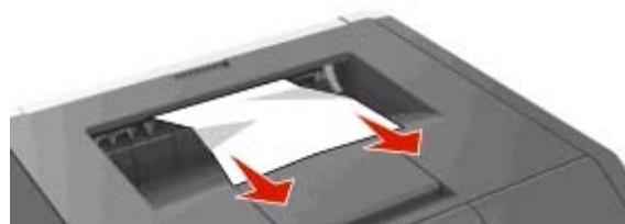
2 Drücken Sie auf dem Druckerbedienfeld , um die Meldung zu löschen und den Druckvorgang fortzusetzen. Wählen Sie bei Druckermodellen ohne Touchscreen **Weiter > OK >Beseitigen Sie den Stau und drücken Sie "OK" > OK**
