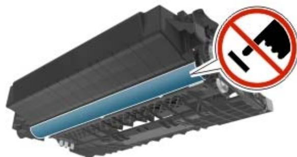
4 Legen Sie die Belichtungseinheit auf eine ebene, glatte Oberfläche.
