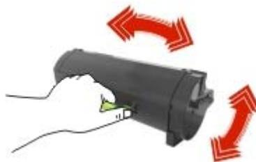
5 Setzen Sie die Tonerkassette in den Drucker ein, indem Sie die seitlichen Führungen der Kassette auf die Pfeile an den seitlichen Führungen im Drucker ausrichten.
